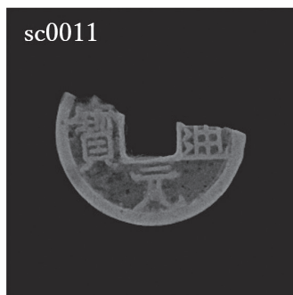
付録1. X線透過像 管電圧225 kV, 管電流2 mA, 時間60秒
